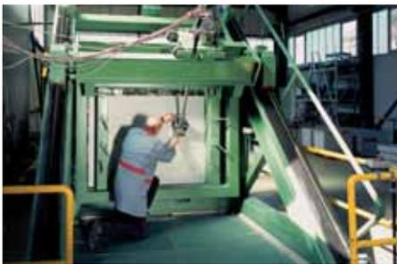
Для проведения испытаний со статическими трещинами, соответственно с открытыми или закрытыми трещинами, имеется оборудование для приложения параллельных и изгибающих нагрузок. Испытания по воздействию на анкеры долговременных нагрузок проводятся в полностью контролируемых внешних условиях.
